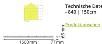
Technische Daten Ledvance LED Feuchtraumleuchte Feuchtigkeitsdicht Value 50W 6000lm - 840 | 150cm
